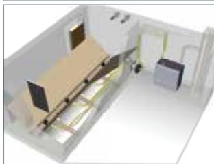
Ein 30 kg Tagesbehälter im Kessel reduziert die Laufzeit der Pelletsförderung auf 1 bis 2 mal je 5 Minuten am Tag. Die bevorzugte Tageszeit für die Förderung kann in der Regelung eingestellt werden.
